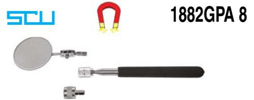
Tipo telescopico con magnete di grande portata, impugnatura in materiale antiscivolo, combinato con 2 specchi OVALI snodati di dimensioni mm 45x30 e 69x46, staccabili. Lunghezza chiuso/aperto senza specchio mm 210/800.
